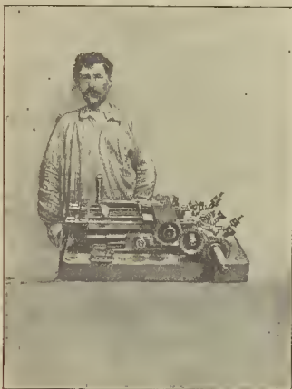
Fig. 1. — Máquina Castelneau de 30 caballos de fuerza y 150 kilogramos de peso
